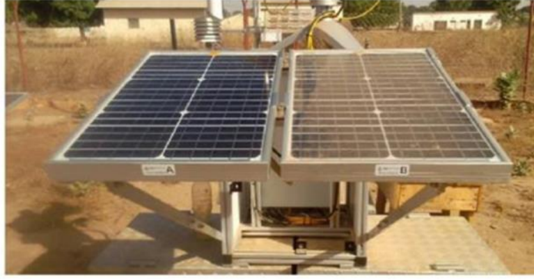
Figure 14. Clean and soiled PV modules at Serebou (Côte d'Ivoire)
